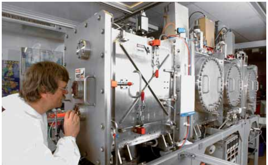
Beschichtungsanlage für Solarzellen
