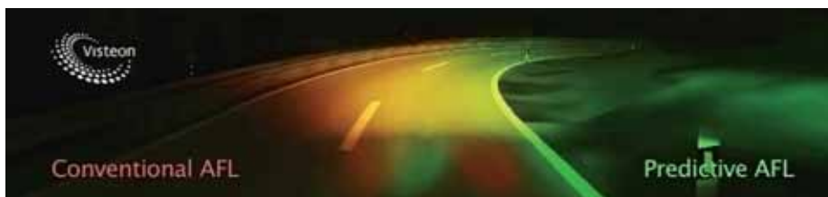
Bild 2: P-AFL (grün) schwenkt die Scheinwerfer früher als konventionelles AFL (rot)
